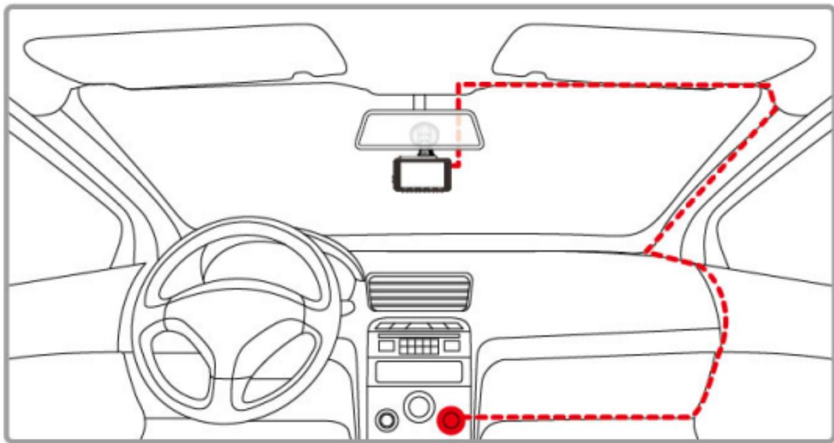
1. 電源供應器的一端連接到記錄器的 **USB** 埠。電源連接孔輸入直流電壓 **5V/2A**。
