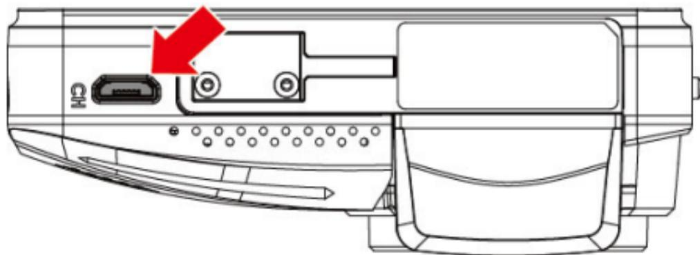
2. 將傳輸線的另一端插入後鏡頭的耳機孔。
