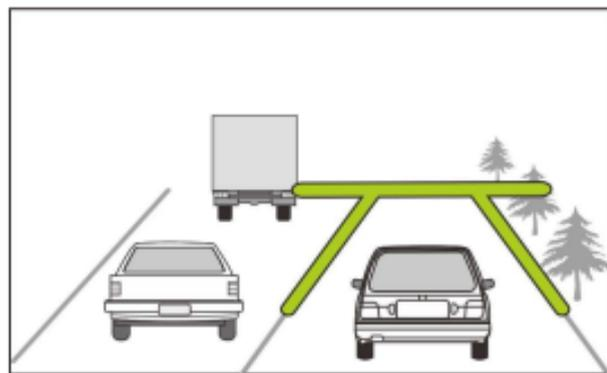
當衛星定位完成後行車時速達 60 km/h 以上且與前方車距低於 30 公尺時，設備會發出語音與警示畫面提醒。
