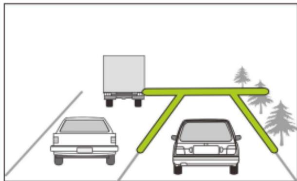
當衛星定位完成後，行車時速達 70 km/h 以上且偏離行駛車道或變換車道時，設備會發出語音與警示畫面提醒。
